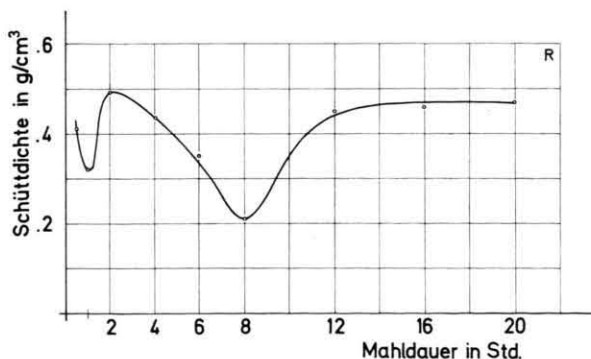
Abb. 4. Schüttdichte in Abhängigkeit von der Mahldauer.
